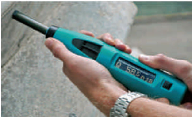
Determinazione indice di rimbalzo mediante prova sclerometrica.
