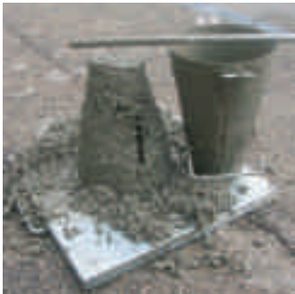
Misura della consistenza del cemento fresco (Slump Test)
