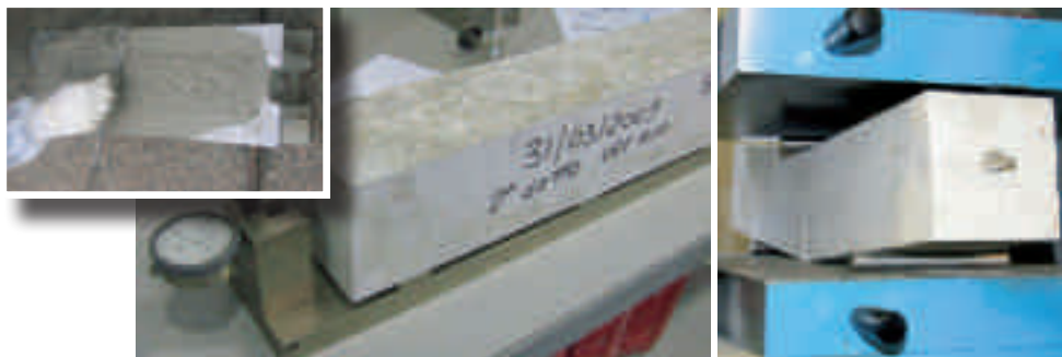
■ Determinazione del ritiro idraulico del calcestruzzo fresco
