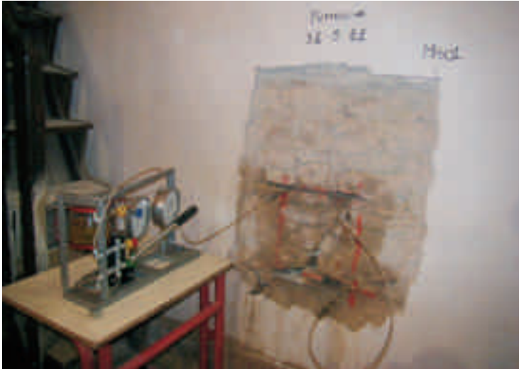
Prova con martinetti Doppio eseguita presso la Parrocchia S.Maria degli Angeli Santuario Diocesano di San Pio da Pietrelcina, Pietrelcina (BN)
