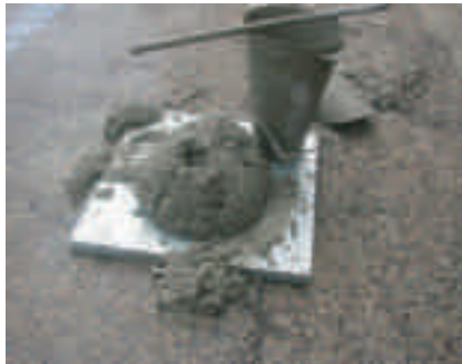
Misura della consistenza del cemento fresco (Slump Test)
