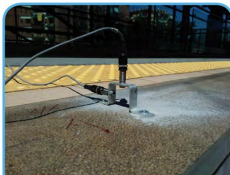
Monitoraggio delle vibrazioni indotte sulle strutture limitrofe ad una stazione ferroviaria
