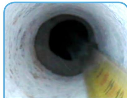
Esame endoscopico per l'individuazione della tipologia e dello spessore della struttura muraria
