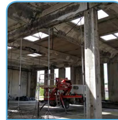
Prova di carico con martinetto a tiro (Prova con carico concentrato)
