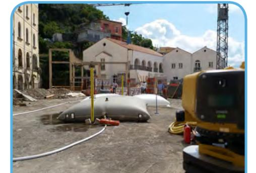
Prova di carico con serbatoio idraulico (Prova con carico distribuito)
