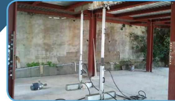
Prova di carico con martinetto a spinta (Prova con carico concentrato)
