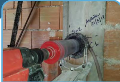
Prelievo di provini cilindrici di calcestruzzo eseguiti con sonda a corona diamantata in accordo alla norma UNI EN 12504-1
