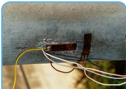
Misura di micro spostamenti mediante strain gauge (Tensioni)
