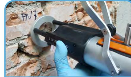
Prova penetrometrica su malta per la valutazione della resistenza meccanica della malta
