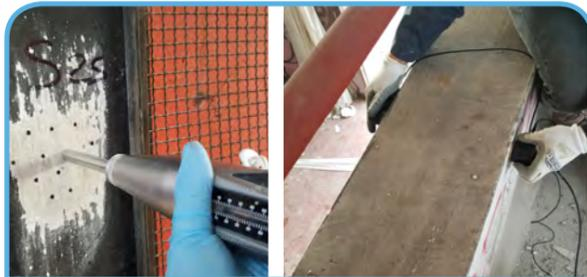
Metodo SonReb: indagine sclerometrica più ultrasuoni per una verifica indiretta della resistenza del calcestruzzo in opera
