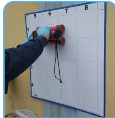
Indagine pacometrica per l'individuazione delle armature e la loro posizione negli elementi strutturali
