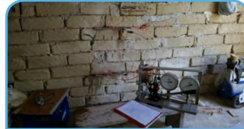
Prova con martinetti piatti per la determinazione dello stato tensionale esistente e la resistenza a rottura della muratura
